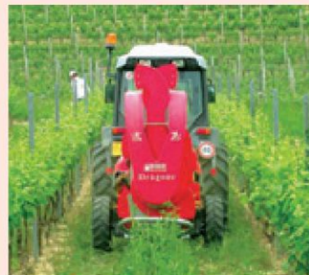
Trattore con cabina pressurizzata.
